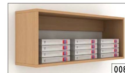
008 NÁSTĚNNÁ POLICE - LTD 18 mm, ABS hrana, lepené spoje - rozměr (šxvxhl) 80 x 37 x 24 cm - kotvení napevno ke zdi - dezén LTD buk
