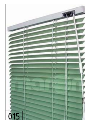
015 HORIZONTÁLNÍ ŽALUZIE DO OKENNÍHO RÁMU - horní lišta U profil (hřidel + naklápěcí mechanismus) - boční vedení (lanka vypnutá do rámu okna) - šíře lamely 25 mm (celostínící provedení), barva dle rámu okna - ovládání naklápění plast. tyčkou - shrnování nekonečným provázkem - rozměr 210 x 150 cm (015.1)
